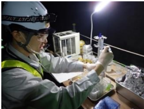
ボーリング孔掘削水の トレーサー濃度管理の様子
