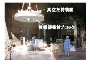
真空把持装置を鉛直に上昇させ、緩衝材ブロックが落下しないことを確認。
