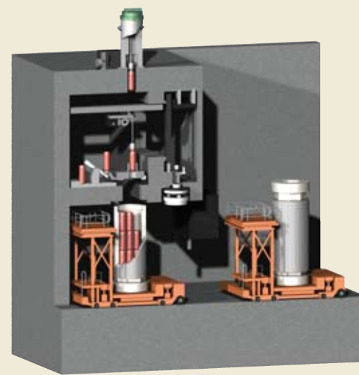
輸送容器からガラス固化体を取り出し、検査します。
