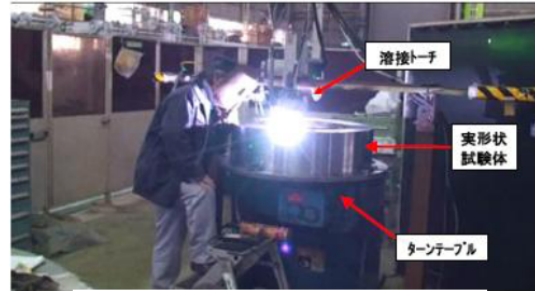
図-4 実形状供試体 溶接状況
