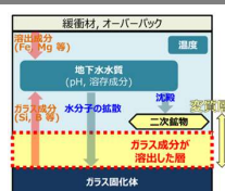
図.1 ガラス・地下水の界面で生じるプロセス図
