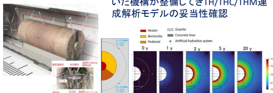
図.2 HotBENTを対象とした連成解析（左：試験体系、右：TH連成解析例）
