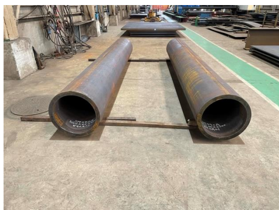
電炉品で製作した板巻鋼管の試作品 （委託先工場にて）
