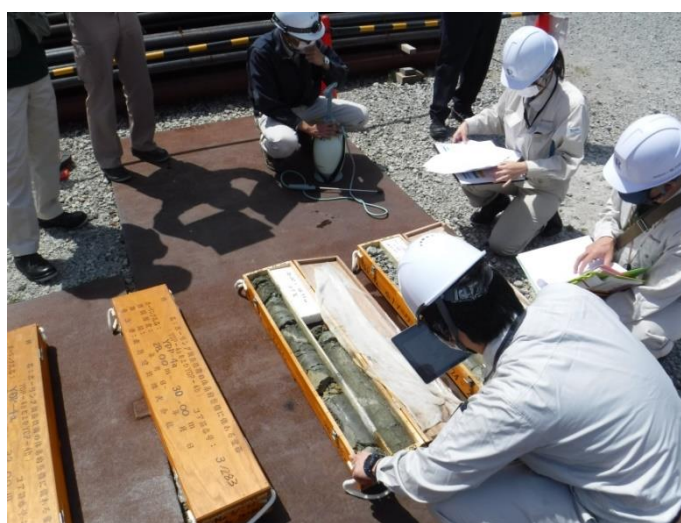
採取したボーリングコアの確認
