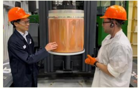
銅コーティングの品質確認のための電気メッキ試験の様子
