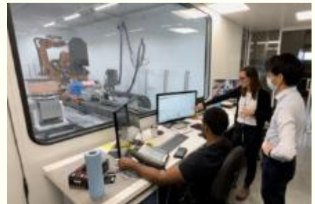
オーバーパックの容器部分と蓋部分の継目部分を銅でコーティングするための冷間溶射試験の様子
