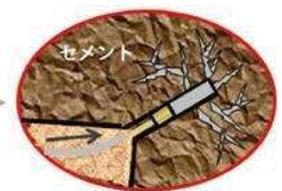
セメント系材料を岩盤内に注入し、隙間をふさぎます。
