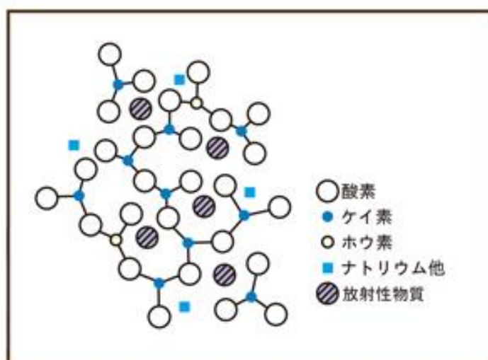
ガラス固化体の閉じ込め能力
