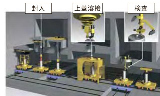
遠隔操作技術を用いてガラス固化体をオーバーパックへ封入し、上蓋を溶接します。
