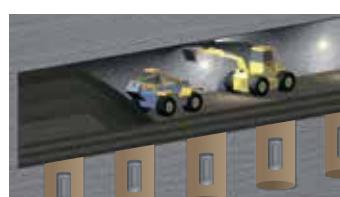
※地上でガラス固化体、オーバーパック、緩衝材を専用の容器(PEM(Prefabricated Engineered Barrier Module)容器)に入れ、それを地下に「横置き」に定置する方法も検討されています。
