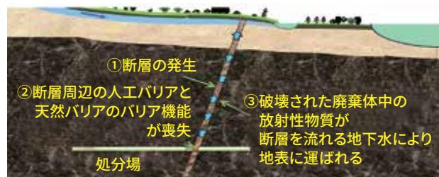
地下水により放射性物質が地表まで運ばれるようなケースについては、岩盤、地下水の特性の違いや、人工バリア、天然バリアの性能が最もありえそうな想定より低い場合を設定するなどして、多数のケースを解析しています。
