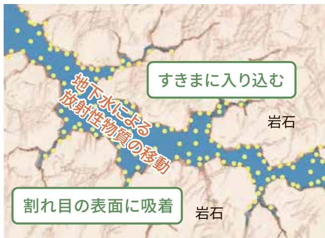
地下深部では酸素が非常に少ないため、オーバーパック(金属製容器)の腐食が進みにくく、放射性物質が地下水に溶けにくい特徴があります。また、地下水の動きが極めて遅いというえに、放射性物質には岩盤に吸着されやすい性質があるため、放射性物質の移動は非常に遅くなります。
