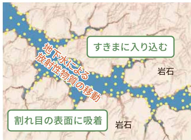
地下深部では酸素が非常に少ないため、オーバーパック(金属製容器)の腐食が進みにくく、放射性物質が地下水に溶けにくい特徴があります。また、地下水の動きが極めて遅いという点で、放射性物質には岩盤に吸着されやすい性質があるため、放射性物質の移動は非常に遅くなります。
