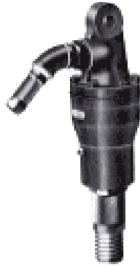
図 2.12.3-2 ウォーターホイスチングスイベルの例
