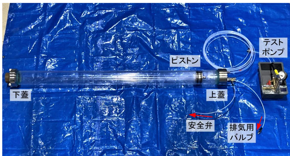
図 2.13.8-1 貸与予定の模擬運搬装置の外観
