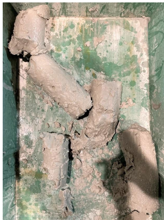
図 2.13.8-5 模擬発出試験後のベントナイトの状況 (B)
