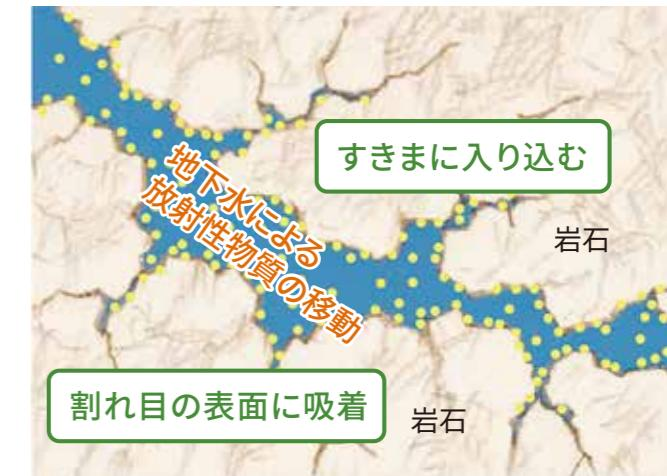
地下深部では酸素が非常に少ないため、オーバーパック(金属製容器)の腐食が進みにくく、放射性物質が地下水に溶けにくい特徴があります。また、地下水の動きが極めて遅いうえに、放射性物質には岩盤に吸着されやすい性質があるため、放射性物質の移動は非常に遅くなります。
