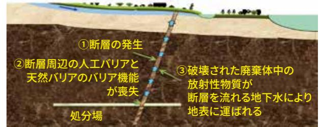
地下水により放射性物質が地表まで運ばれるようなケースについては、岩盤、地下水の特性の違いや、人工バリア、天然バリアの性能が最もありえそうな想定より低い場合を設定するなどして、多数のケースを解析しています。
