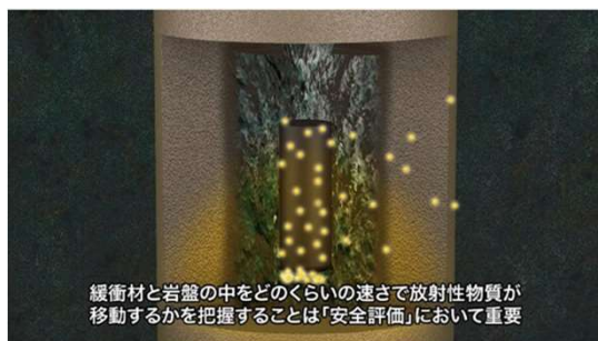
② 放射性物質が人工バリア内を移動する様子
