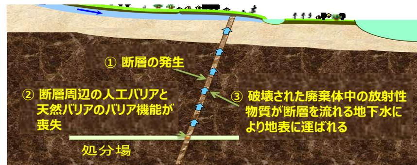
地下水により放射性物質が地表まで運ばれるといったケースについては、岩盤、地下水の特性の違いや人工バリア、天然バリアの性能が基本の想定より低い場合を設定するなど、多数のケースを解析しています。
