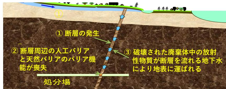
地下水により放射性物質が地表まで運ばれるといったケースについては、岩盤、地下水の特性の違いや人工バリア、天然バリアの性能が基本の想定より低い場合を設定するなど、多数のケースを解析しています。
