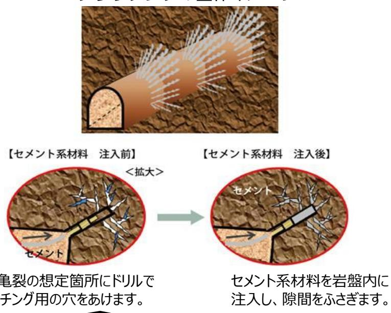
グラウチングにより、地下水量を1/100程度まで減らせることを実証済。岐阜県瑞浪市の地下研究所における研究では、 $1,380\text{m}^3/\text{日}$ の湧水が想定されていた箇所をグラウチングすることで $15\text{m}^3/\text{日}$ まで低減。
