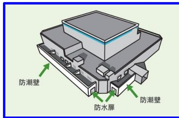
津波時の地上施設への浸水防止策
