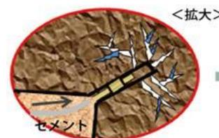
湧水亀裂の想定箇所ドリルでグラウチング用の穴をあけます。
