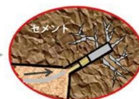
セメント系材料を岩盤内に注入し、隙間をふさぎます。
