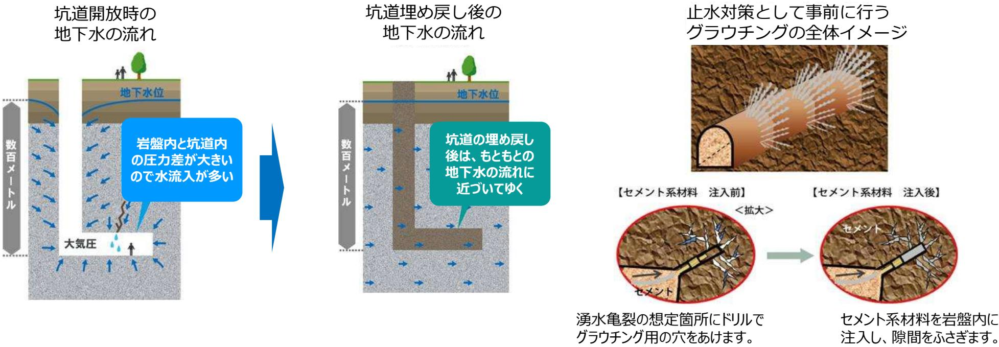
グラウチングにより、地下水量を1/100程度まで減らせることを実証済。岐阜県瑞浪市の地下研究所における研究では、 $1,380\text{m}^3/\text{日}$ の湧水が想定されていた箇所をグラウチングすることで $15\text{m}^3/\text{日}$ まで低減。
