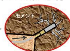
【セメント系材料 注入後】
