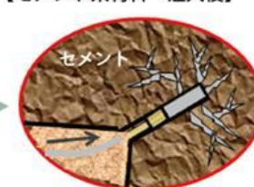
【セメント系材料 注入後】
