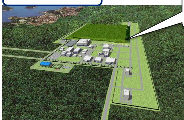
ガラス固化体を金属製容器に密封する施設など
