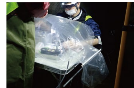
地下水の採取作業
