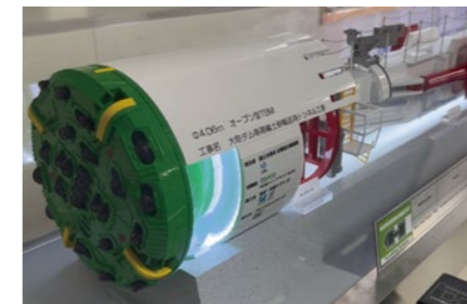
TBMの先端(模型)
