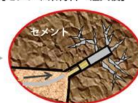
【セメント系材料 注入後】
