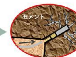
【セメント系材料 注入後】
