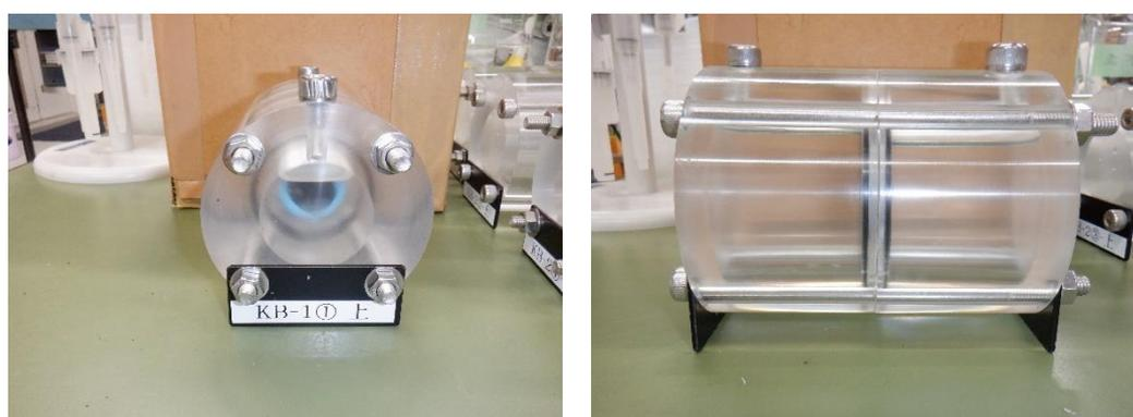
図 8.1.1-4 透過拡散試験装置の外観
