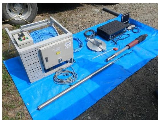
図 6.2-1 マルチフローメータシステム一式
