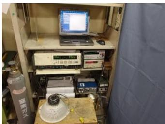
図 5.1-1 熱線法による熱伝導率測定装置
