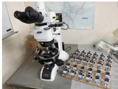
図 4.2-2 メカニカルステージを設置した偏光顕微鏡とポイントカウントツール
