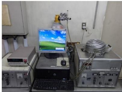
図 5.2-1 断熱型連続法による比熱測定装置
