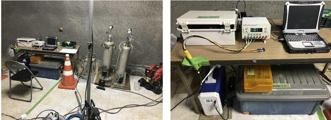
図 6.3.1-3 間隙水圧の測定状況
