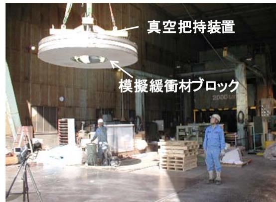
真空把持装置を鉛直に上昇させ，緩衝材ブロックが落下しないことを確認。
