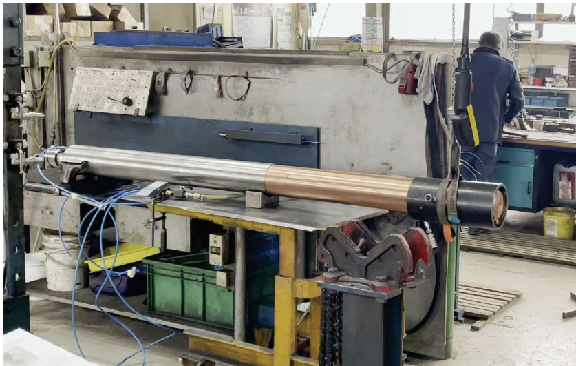
図 5 ブリッジプラグ性能確認試験状況
