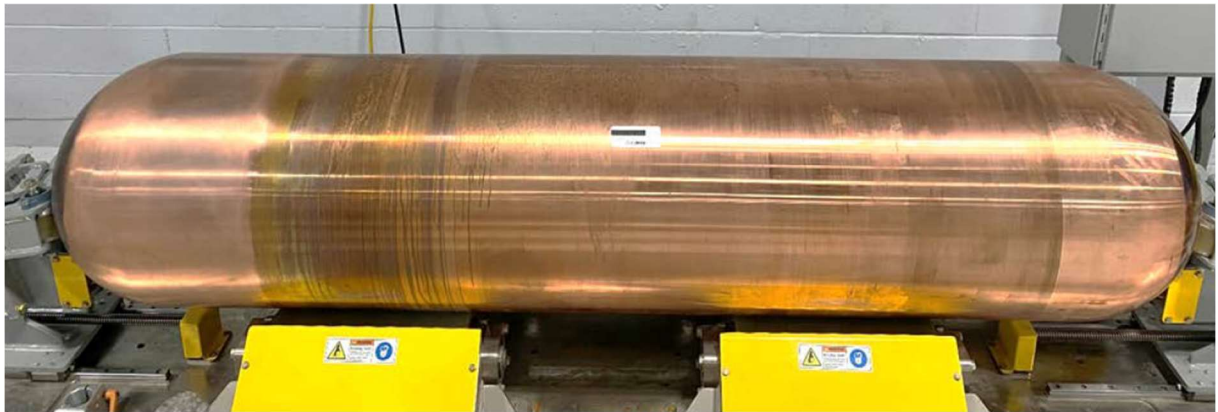
図 3 連続製造試験において試作した銅コーティングオーバーパックの例 (NWMO, 2024)
