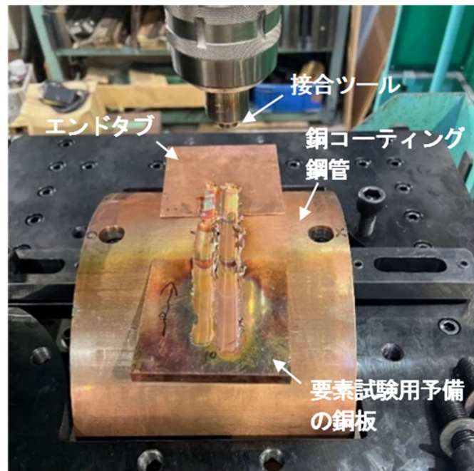
図 5 エンドタブを用いた FSW 試験の様子 (写真手前側が接合始端)
