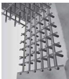
耐震性を高めるための鉄筋コンクリート壁
