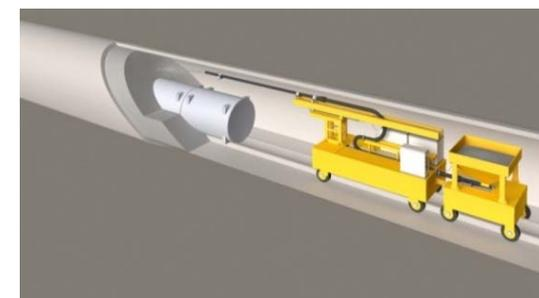
吹付け工法による坑道の埋め戻し作業のイメージ（横置き方式）
