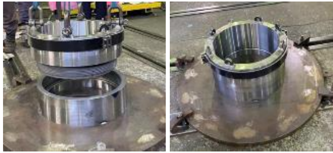
図②-17 ねじ込み接合試験（左：接合前、右：接合後）
