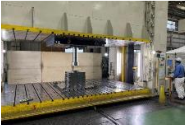
図②-11 緩衝材プレス試験状況
