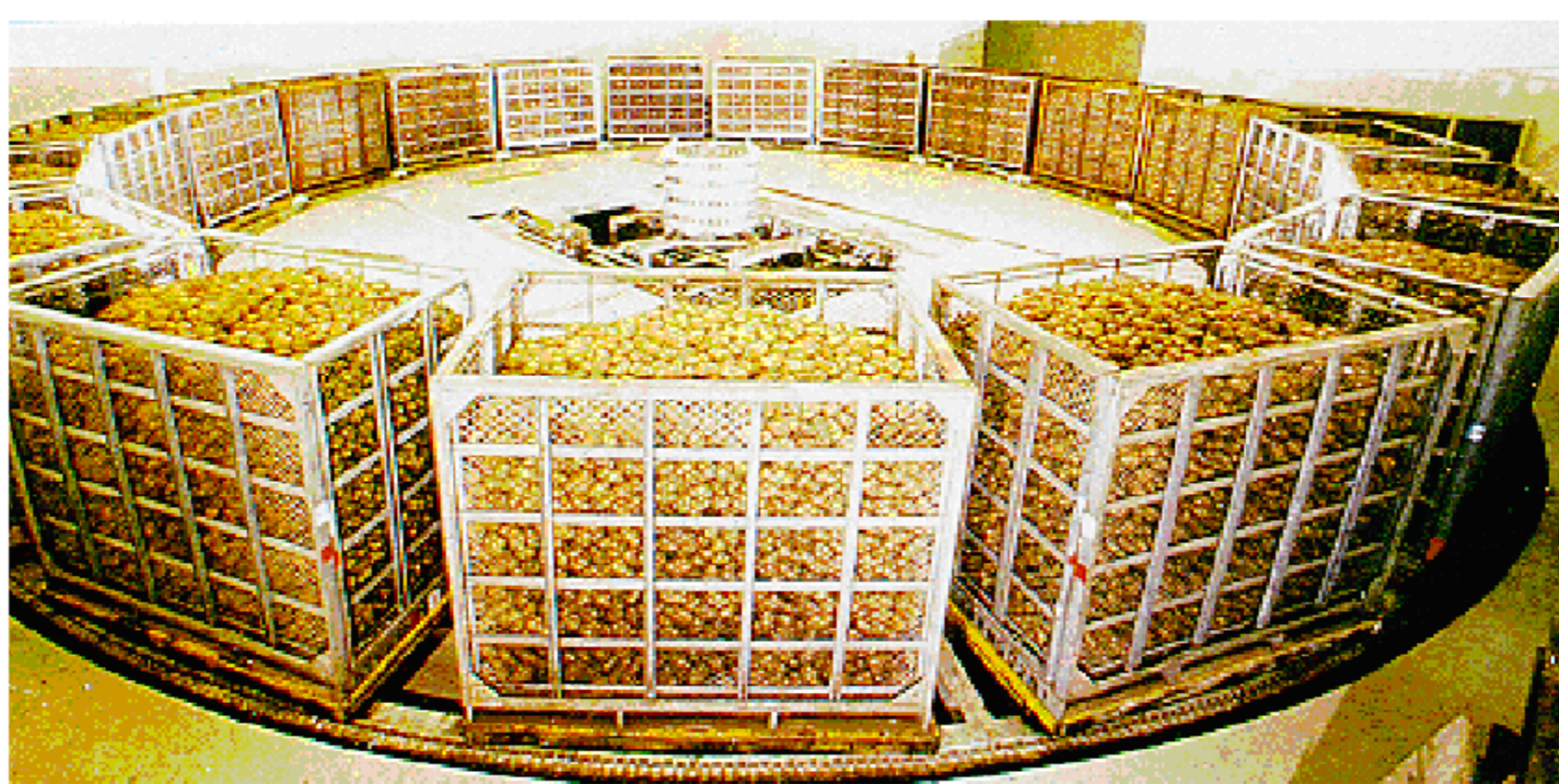
図4 北海道士幌農協のジャガイモ照射施設の内部
