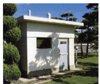
◀ 放射線モニタリングポストの例 (写真提供：国立研究開発法人日本原子力研究開発機構)
