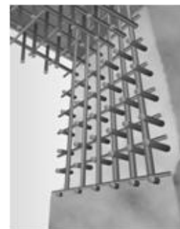
耐震性を高めるため鉄筋コンクリート壁
