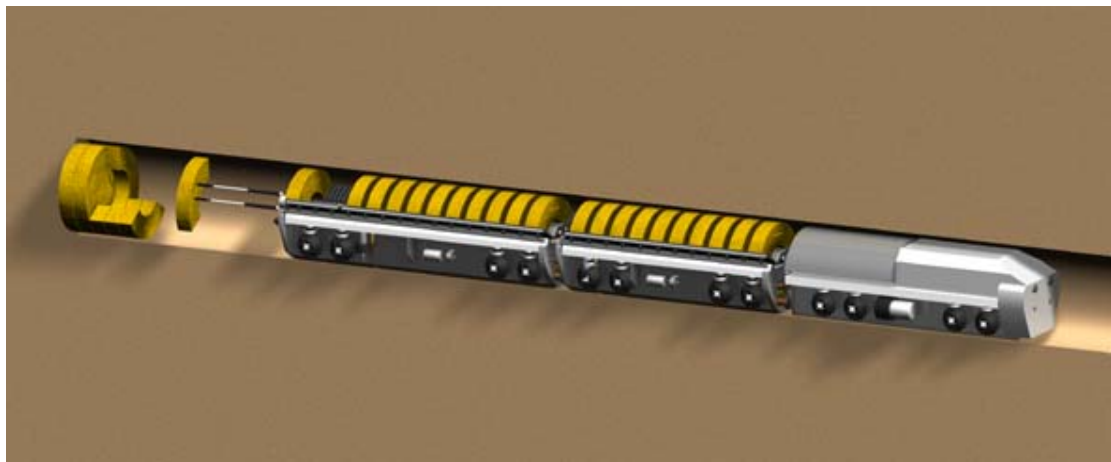
図 5.2.3-15 処分坑道横置き方式の緩衝材定置装置の概念図
