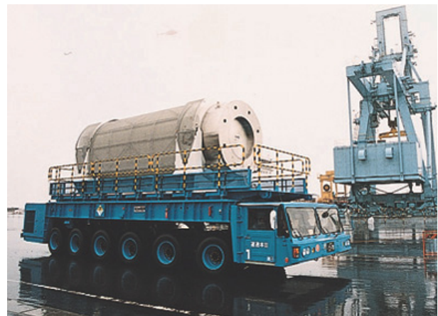
図 5.2.3-2 返還ガラス固化体の輸送に使用されている輸送車両 （出典：日本原燃株式会社，2000）
