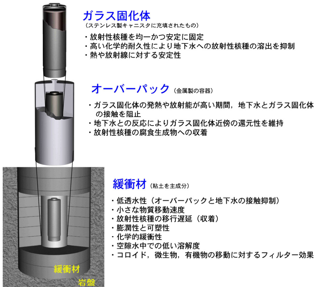
図 4.1-1 人工バリアの基本概念と期待される安全機能 (核燃料サイクル開発機構, 1999a を参考に作成)
