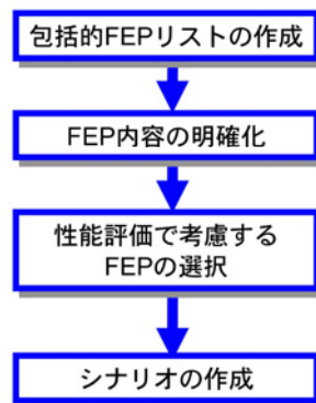
図 6.2.3-2 シナリオの検討手順 (核燃料サイクル開発機構, 1999a に基づき作成)
