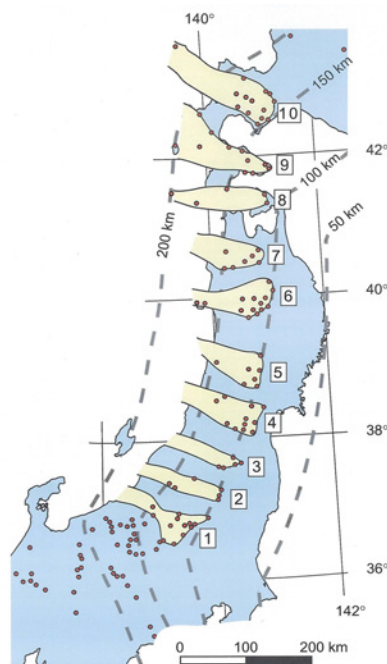
図 3.3.2-5 東北日本の第四紀火山の分布 (出典 : Tamura et al., 2002) 火山の集中域と空白域が交互に出現する。点線は沈み込む太平洋プレート表面の等深度線。
