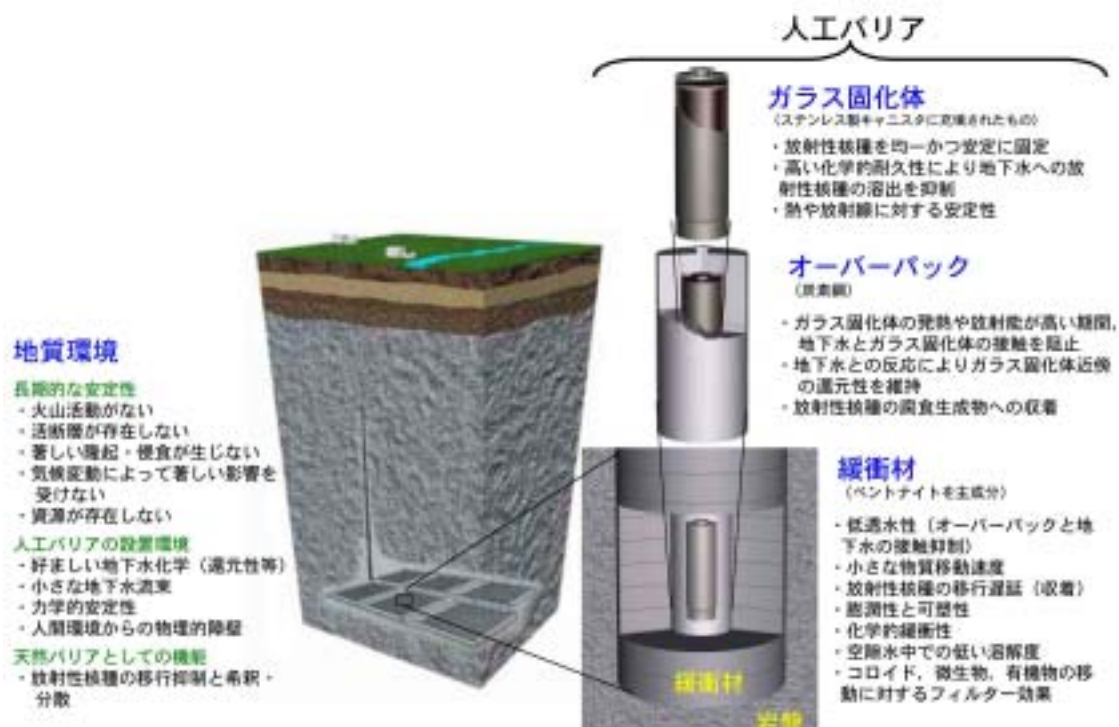
図-3.1 処分場の構成要素と期待される安全機能 (核燃料サイクル開発機構, 1999a を参考に作成 ; 原子力発電環境整備機構, 2004a)
