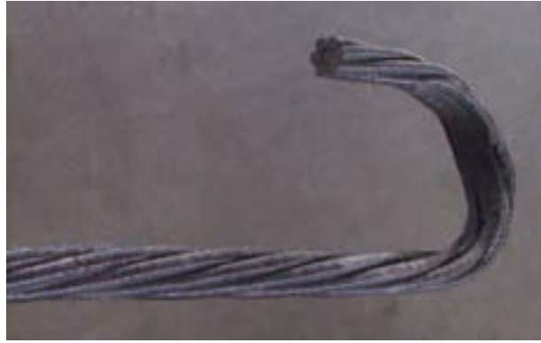
図 2.3-13 炭素繊維複合材ケーブル (CFCC) の外観
