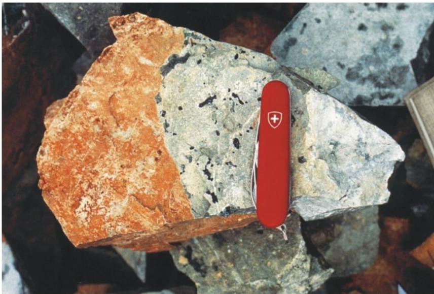
岩石中の小規模の酸化還元フロント（注：ナイフはスケールの比較のため設置）。左側のオレンジがかった赤の部分が酸化領域で、右側の灰色の部分が還元領域（Waber et al., 1990）。
