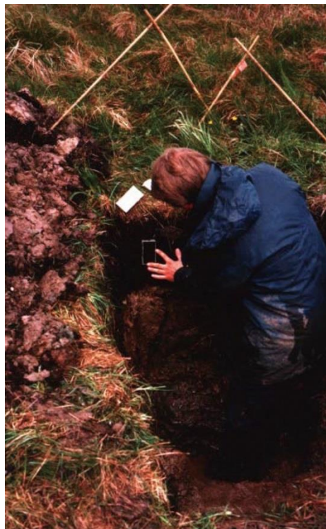
クビエナボックス（ブリキ製容器）を使用した、ブロブスタのナチュラルアナログサイトにおける擾乱を受けていない土壌と堆積物のサンプル採取 (Milodowski et al., 1989. ©British Geological Surveyより)
