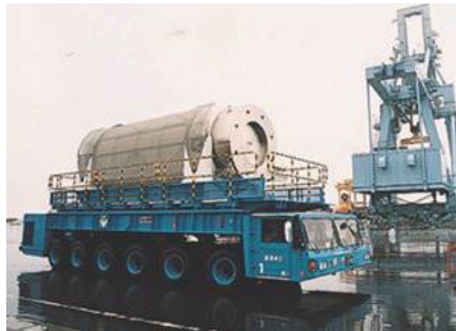
図 6.4.2-1 返還ガラス固化体の輸送に使用されている輸送車両 (写真提供：日本原燃株式会社)
