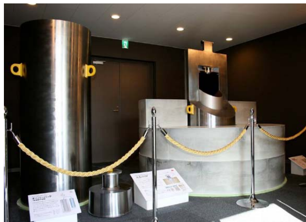
図 6.6.4-7 製作された炭素鋼オーバーパック （出典：原環センター，2010e）
