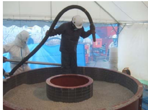
(b) 実規模縦型処分施設吹付試験状況
