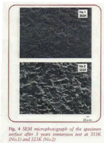
図 2 試験後試験片表面の SEM 観察結果 (人工海水中 3 年間浸漬，上段：80℃， 下段 50℃)
