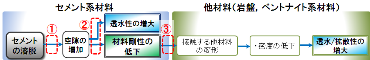
図 2.4-30 セメントの溶脱に伴う空隙の増加を起因とする関連事象
