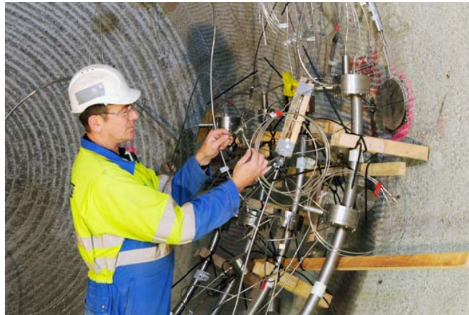
図 2-13 測定器の設置状況 (間隙水圧, 膨潤圧, 温度など) (NAGRA, 2013c)
